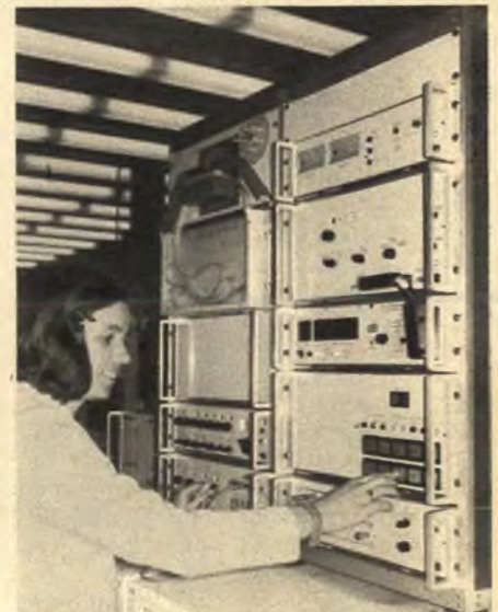
Bild 1. Ausführungsbeispiel eines programmgesteuerten Meßautomaten mittlerer Größe – aufgebaut aus Pegamat-Bausteinen – zum Messen von Pegeln, Dämpfungen, Pegel- und Dämpfungsdifferenzen. In dem Grenzwertvergleich (rechts oben) werden die Meßwerte mit von Hand oder vom Programm her einstellbaren Toleranzen verglichen
