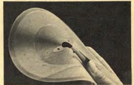
Bild 1. Papierdünn ist die Bildplatte mit dem aufgezeichneten 12-Minuten-Schwarzweiß-Programm. Zu beachten sind das große Mittelloch und die drei kleinen Löcher für eine sichere Führung der Platte bei 1500 U/min
